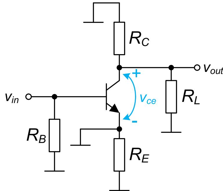
Na slici je prikazano ekvivalentno kolo za AC analizu. Maksimalna vrijednost AC komponente napona kolektor-emitor iznosi:
